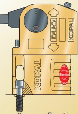
Fixation en plateau modulaire avec une vis spéciale : M10 - M 12 - M 14 - M 16
