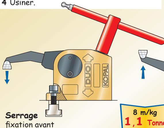
Fixation sur table à rainures avec vis spéciale M10
